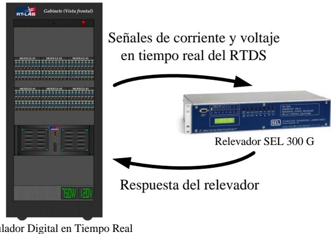
Figura 4. 58 Prueba con relevador SEL® 300G en lazo cerrado.
