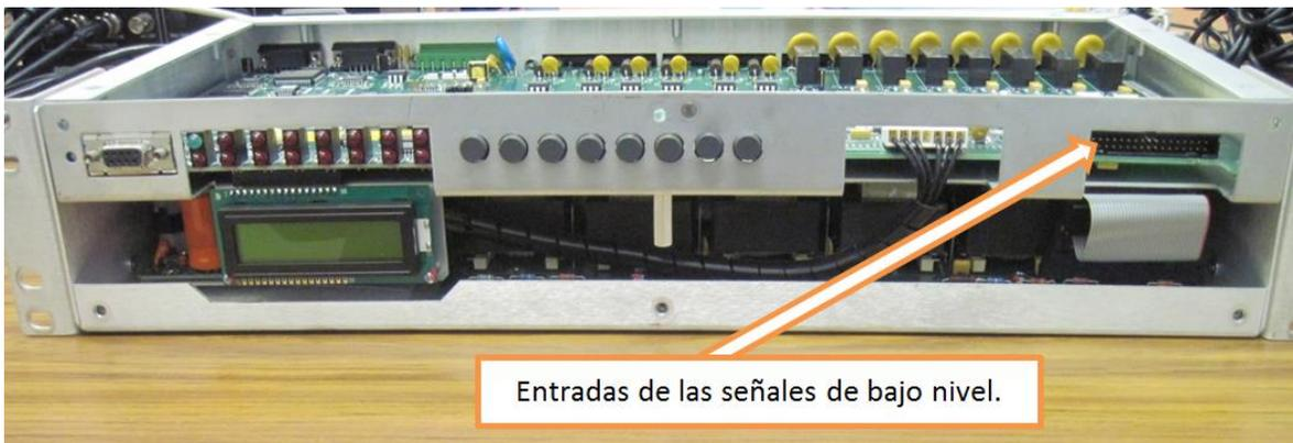
Figura 4. 59 Ubicación de las entradas de bajo nivel del relevador SEL® 300G.
