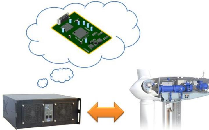
Figura 3. 4 Prototipo de control rápido.
